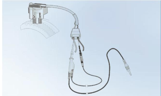
Prueba de un sensor magnético de posición del cigüeñal
