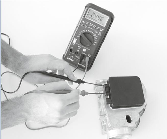
Con el voltímetro, medir la tensión entre los terminales:
