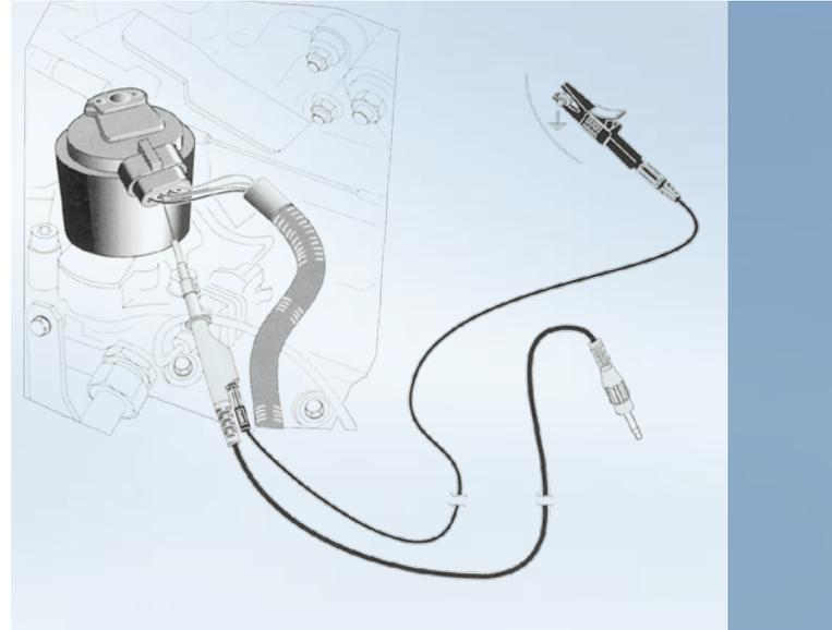
Prueba de una válvula de EGR
